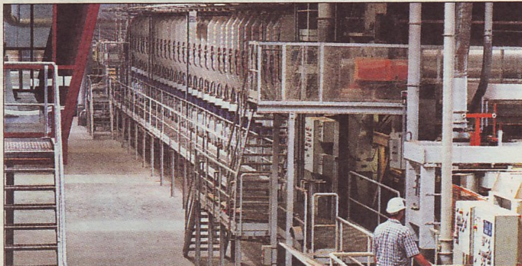
Kontinuierliche Spanplattenpresse mit einer Länge von 38 m
