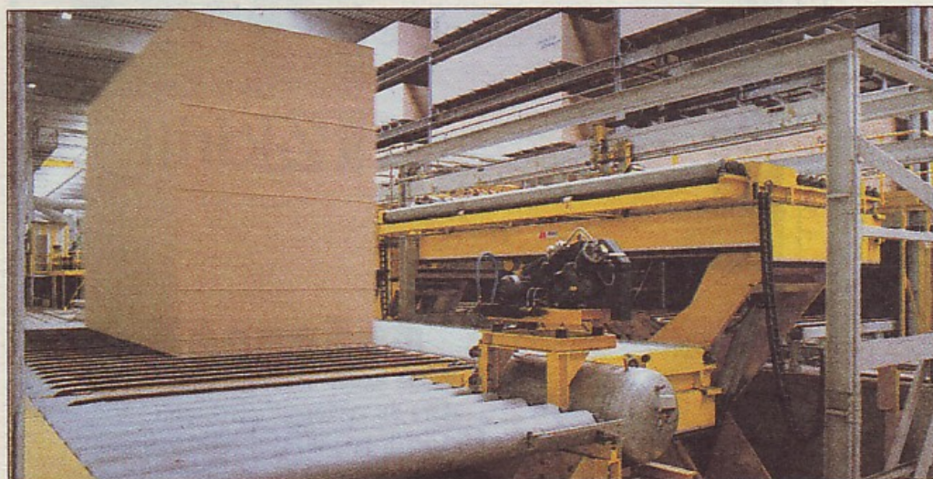
Hochstapelbildung für direktes Weiterverarbeiten – im Hintergrund sind die Regal-lager für normale Stapelhöhen zu sehen
